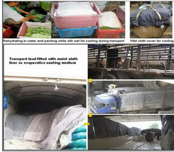
চিত্র ২৬: পরিবহনের সময় ব্যবহৃত ইভাপোরেটিভ কুলিং এবং MAলাইনার
