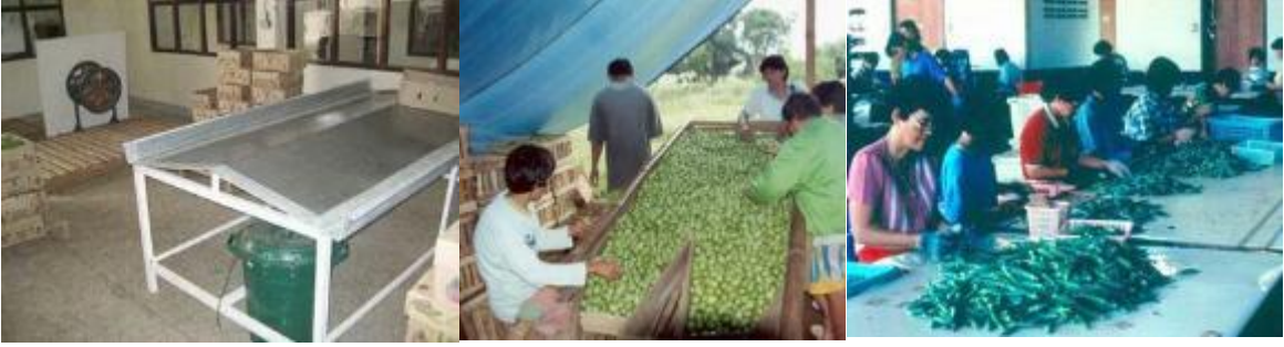
চিত্র ১৫ : কৃষি খামার কিংবা একটি প্যাকহাউজে সর্টিং এর কাজে ব্যবহারের জন্য সর্টিং টেবিল।
